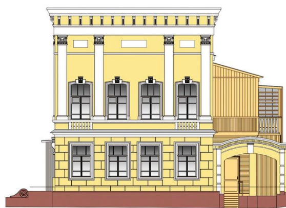
Рис. 7. Фасад по ул. Р. Люксембург, 14. Проект реставрации фасадов памятника архитектуры (НИПФ «Ярканон»)
