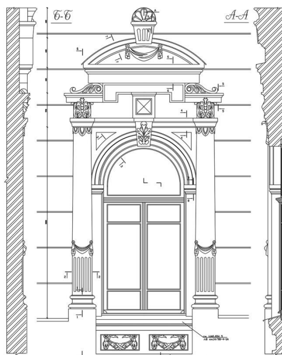
Рис. 3. Окно второго этажа. Рабочий проект деталей фасадов памятника архитектуры «Б. дом Агамжановых, 1909 г.» (НИПФ «Ярканон», 1998 г.)
