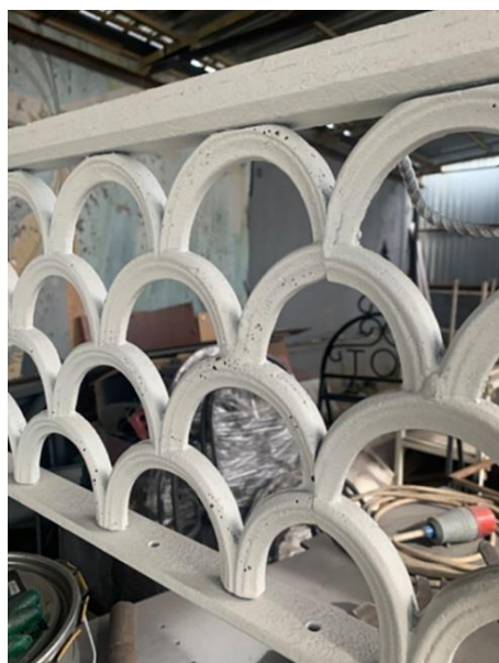
Рис. 10. Крепление направляющих к орнаменту «рыбья чешуя». Фотография Ю. А. Горелик, 2022 г.
